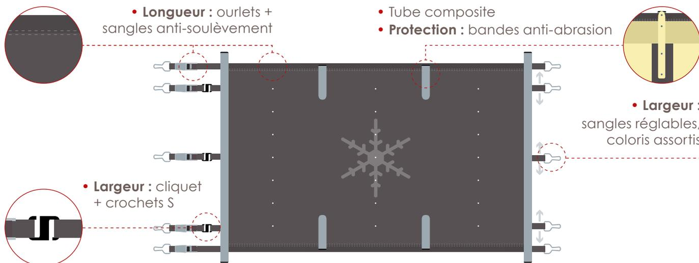
Les couvertures à barres Securit Pool **Summum Flex** sont conçues à partir de tissu enduit PVC 580 g/m<sup>2</sup> et composées d'un système de maintien au moyen de barres composite / pultrusion. Elles sont dotées de cavités pour l'évacuation des eaux pluviales et sont livrées avec une manivelle manuelle démultipliée.
